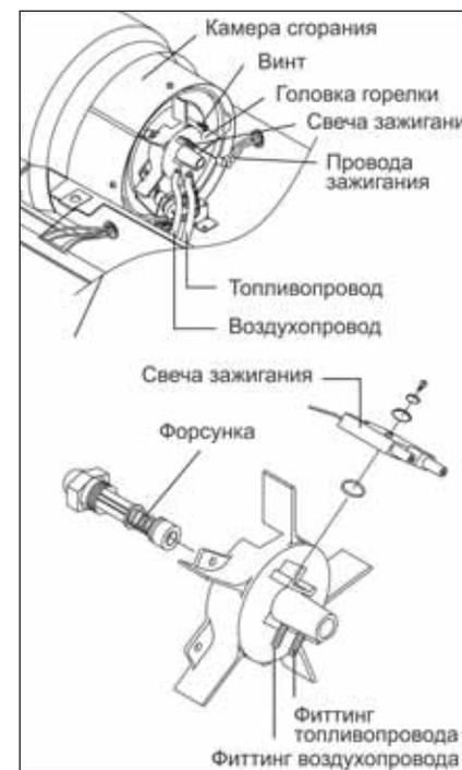
Рис 16. Снятие форсунки
