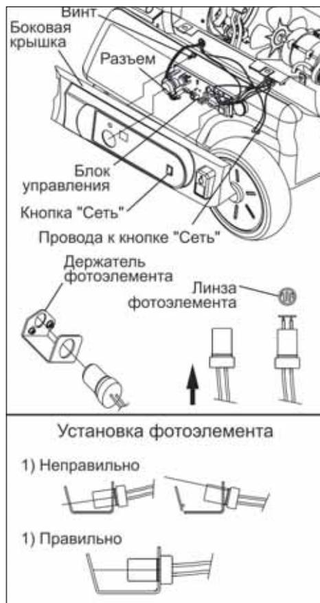
Рис. 18. Снятие блока управления
